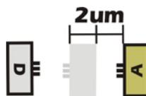
Successivamente la base A completa il proprio ripiegamento arretrando di 2um (in colore grigio più chiaro la posizione della base A prima dell'arretramento).
